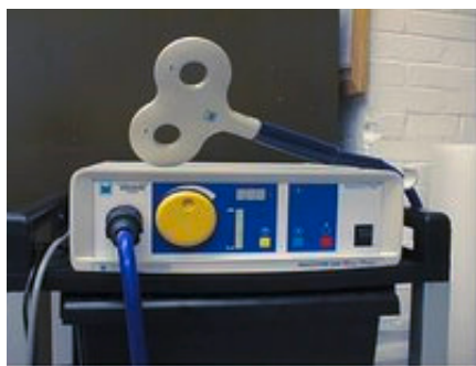
Figure 1a: L'appareil de la TMS avec la bobine de stimulation. Figure de: http://www.acacialab.nl/research/
